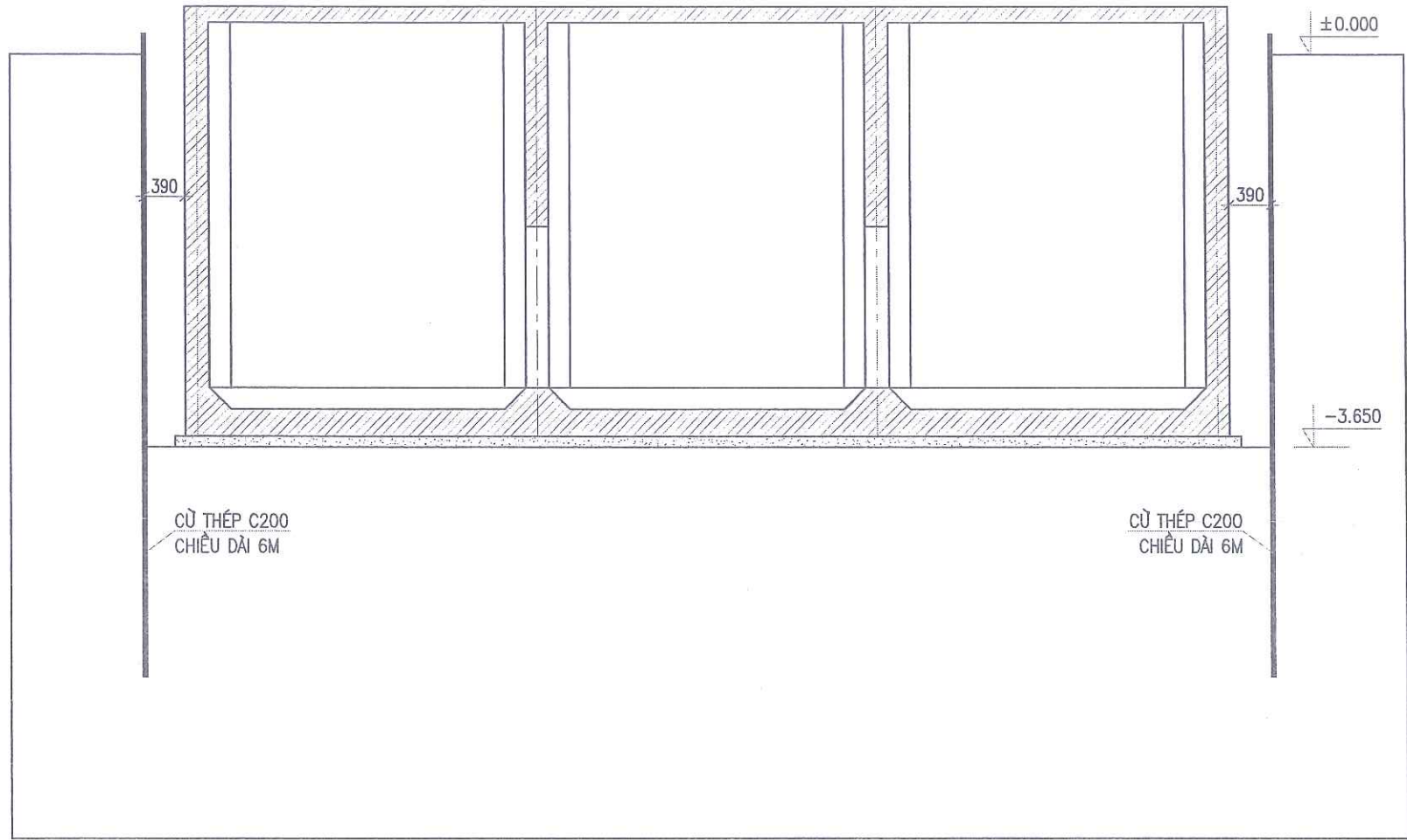
CHI TIẾT GIA CỐ MÓNG BỂ NƯỚC
